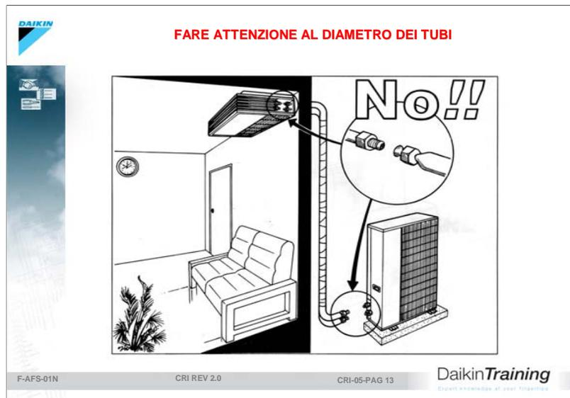
L'esatto diametro delle tubazioni è indicato nel manuale tecnico che accompagna le macchine e deve essere assolutamente rispettato. Per alcuni modelli può essere prevista una soluzione alternativa con diametri diversi; solo in questi casi sarà possibile utilizzare tubi di diverso diametro ma sempre in accordo con le istruzioni contenute nel manuale tecnico. L'utilizzo di tubazioni maggiori o minori di quelle indicate può arrecare gravi danni alla macchina.
